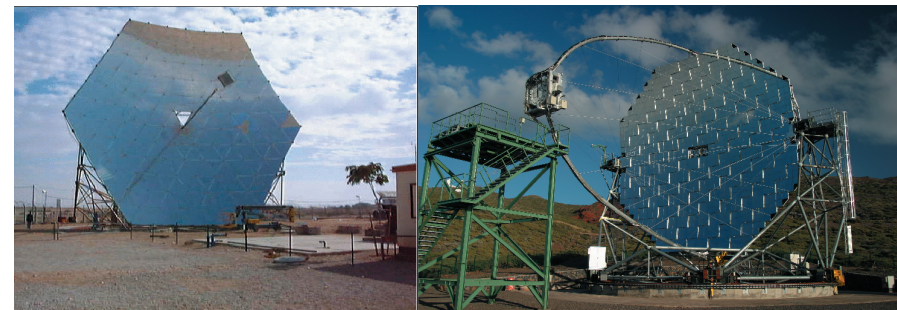
Рис. 4. Слева — солнечный концентратор PETAL, справа — черенковский телескоп MAGIC
