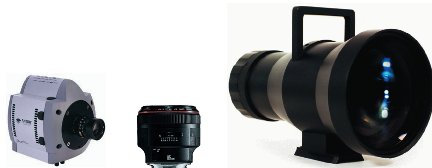
Рис. 14. Возможные массово производимые комплектующие для проектируемой системы. Слева — ПЗС-матрица с внутренним усилением Andor iXon EM +888 с форматом 1024x1024 пикселя размером 13 мкм каждый. Посередине — объектив Canon EF 85 f/1.2 L USM II, способный процировать поле размером 9x9 градусов при масштабе 31"/пиксель на эту матрицу. Справа — объектив Marshall Electronics 140mm f/1.0, который дает поле 5.4x5.4 градусов при масштабе 19"/пиксель
