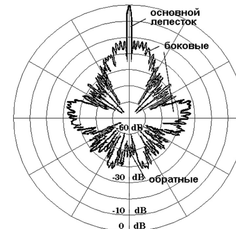
Рис. 2. Пример диаграммы направленности направленной антенны в полярной системе координат. Рисунок воспроизведен с сайта http://radartutorial.eu
